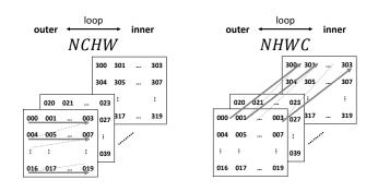
Fig. 6. 一般的な CNN における入力のメモリレイアウト
